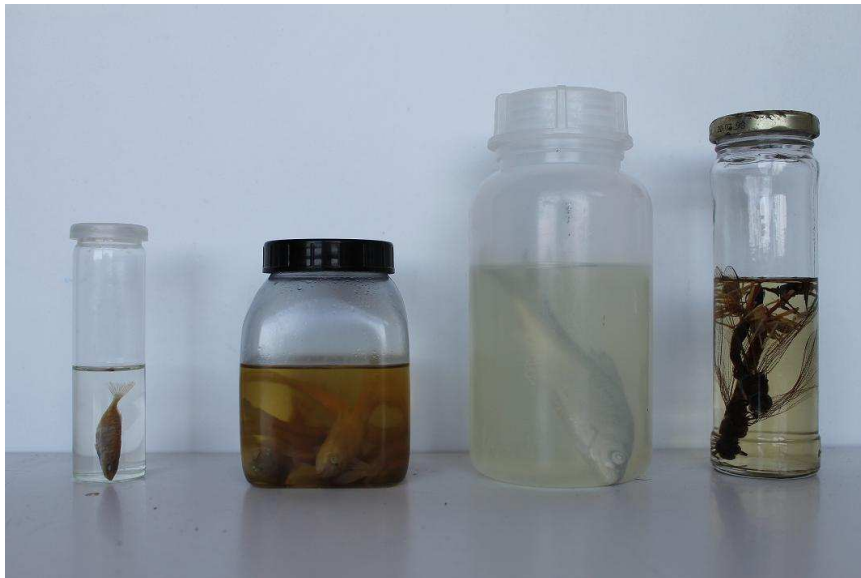
Grundsätzlich zu vermeidende Gefäße und Verschlussvarianten – von links nach rechts: Schnappdeckel aus PVC, PVC-Gefäße (wird bereits oberhalb des Flüssigkeitsstandes aufgrund der Auflösungsprozesse trübe), PE-Gefäße (Kompromisslösung für große Präparate), Olivenglas mit Schraubdeckel aus Metall.
