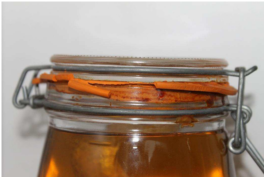
Gummidichtungen (z.B. von Einmachgläsern) können sich unter Ethanoleinwirkung auflösen. UV-Licht lässt sie rasch spröde werden.
