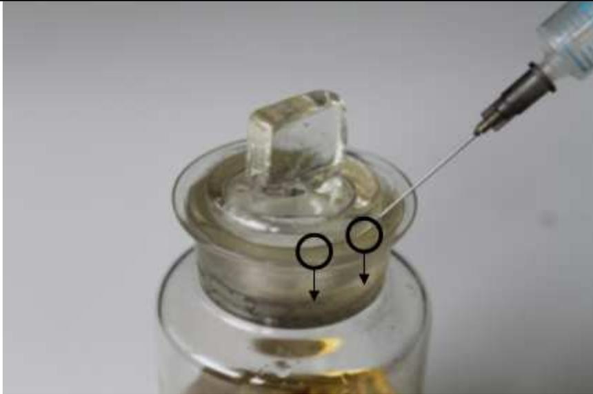
Mithilfe einer dünnen Kanüle kann das Lösungsmittel auf den Spalt zwischen Schliffstopfen und Glas gebracht werden.
